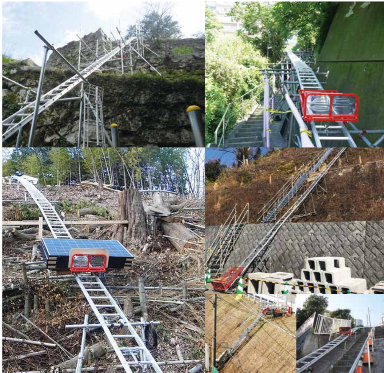
■標準台車 : 台車寸法 (H750×W650×D300) ■ロング台車 : 台車寸法 (H1200×W650×D300)
