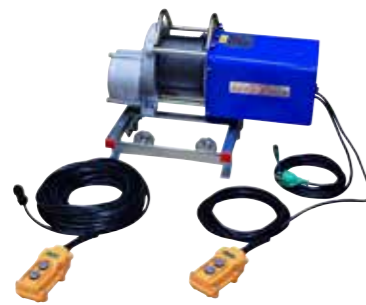
■UP711ZN 引掛けウインチベース付 最大積載量 150kg 巻揚速度 30m/分 操作スイッチコード 5m・15m付 ※オプション使用で無線操作可 ワイヤー巻取 最大5mm×80m
